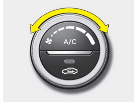
کلید کنترل سرعت فن
