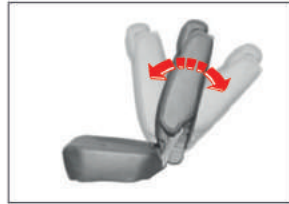
تنظیم زاویه تکیه گاه صندلی عقب
