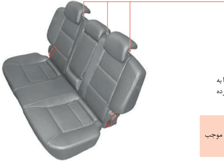
تنظیم زاویه تکیه گاه صندلی عقب
