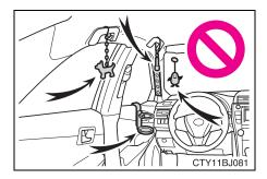
Ne suspendez aucun cintre ou objet dur aux crochets à vêtements. Tous ces objets pourraient se transformer en projectiles et causer des blessures graves, voire mortelles en cas de déploiement des coussins gonflables rideaux SRS.
