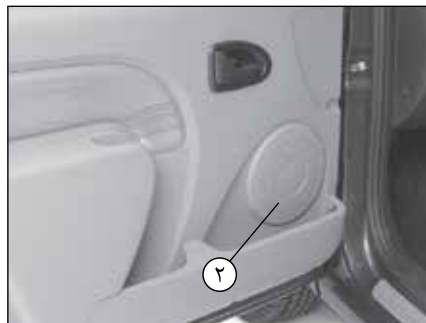
۲ بلندگوهای درب های جلو * بر حسب سطح خودرو، توری ۲ را (با کمک یک ابزار ظریف مانند پیچ گوشتی تخت) بردارید.
