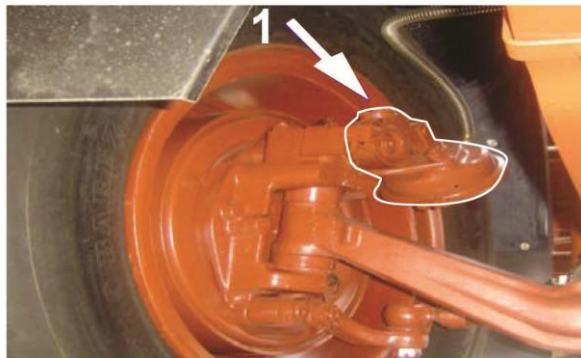
۱- پیچ سر شش گوش تنظیم فاصله لنت ترمز چرخ جلو
